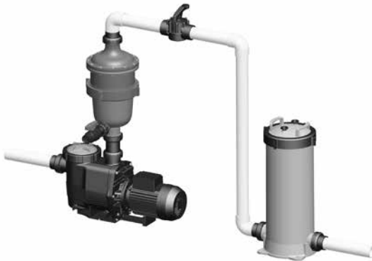
Installation avec filtre à cartouche et robinet d'arrêt à deux voies
