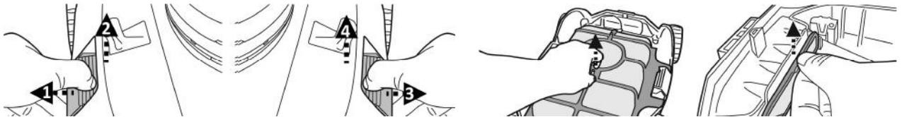
2. Retirer le couvercle filtrant ainsi que la plaque filtrante, puis nettoyer le compartiment à débris. Il est recommandé de nettoyer le couvercle filtrant et la plaque filtrante à l'aide d'un jet d'eau. Si un brossage est jugé nécessaire, utiliser seulement une brosse douce pour nettoyer soigneusement et délicatement. N'appliquer aucune pression sur le filtre.
