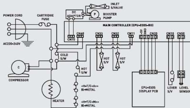
ESQUEMA ELECTRÓNICO MODELOS F Y UF
